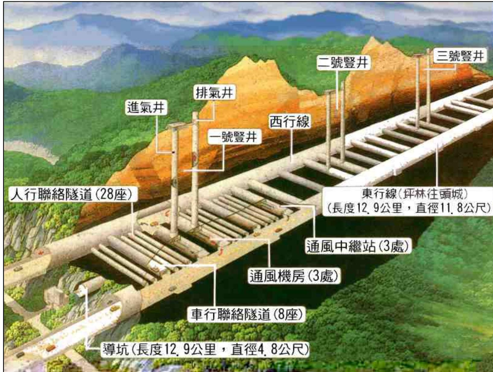
國道新建工程局於雪山隧道的開挖，因四稜砂岩的硬度7，比鋼還硬，開挖非常困難。
